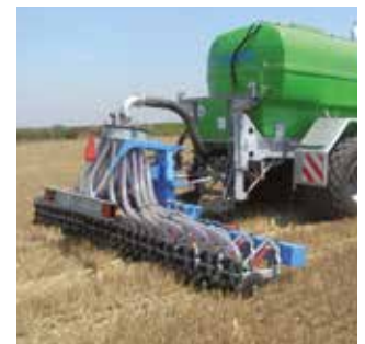
Einbring-Schlitzgerät Innovative Ausbringtechnik
