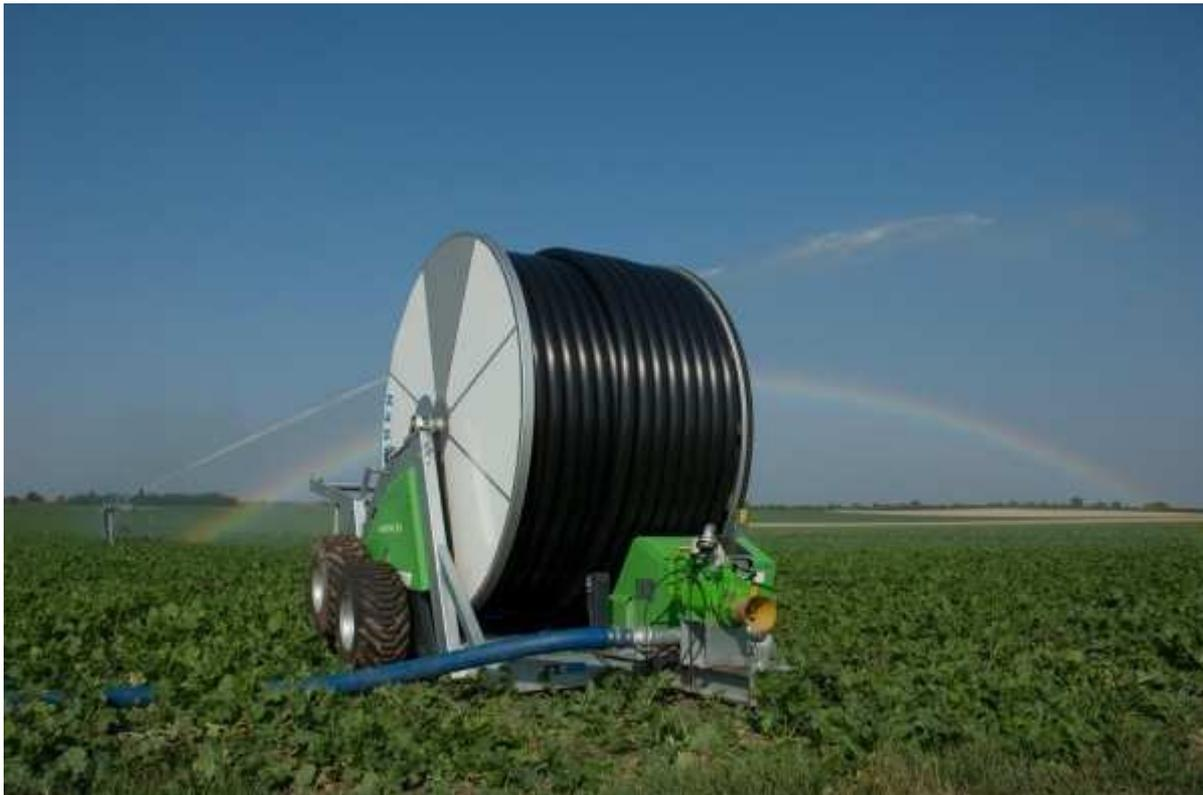
**Der Rainstar E55 der Firma Bauer mit einer Beregnungsbreite von 115 Metern deckt eine Fläche von zehn Fußballfeldern in einem einzigem Beregnungsvorgang ab.**
