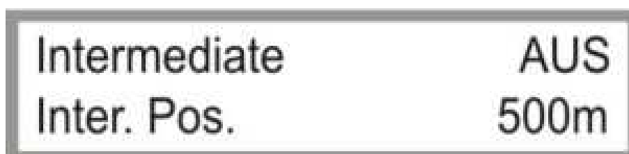
Bild 3.3: Einstellung Zwischenstopp
