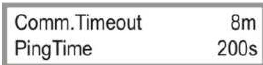
Bild 4.27: Einstellungen Kommunikation und Serverantwortzeit
