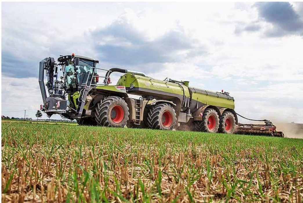
Das Zweiachser-Aufliegefass SGT ST 30000 hat 30.700 Liter Volumen.
