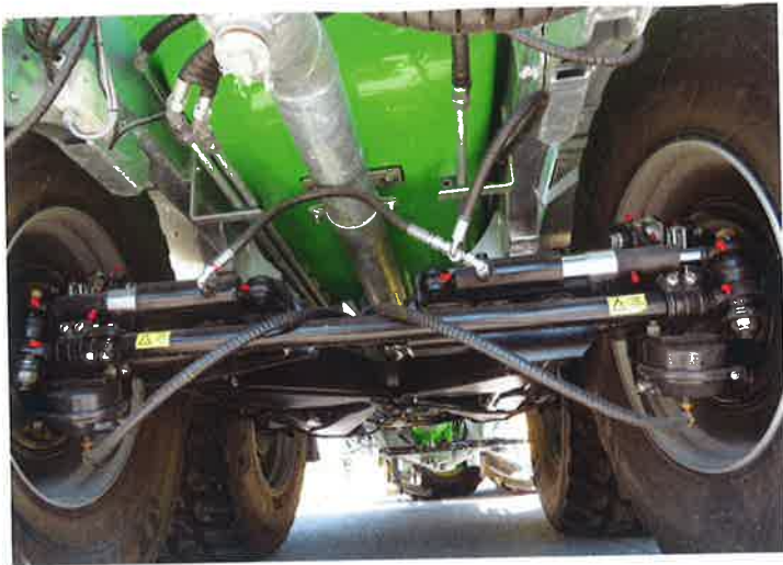
Ein gutes Fahrwerk mit Nachlauflenkung macht sich bezahlt, eine Zwangslenkung ist einfach nachrüstbar.
