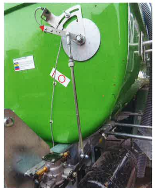
Die Befüllautomatik wird über einen Sensor am Füllstandsanzeiger geschaltet, ebenso die automatische lastabhängige Bremsregulierung.
