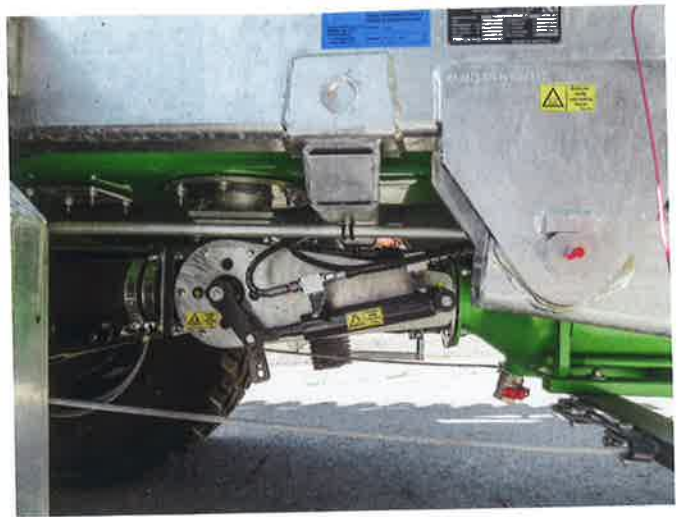
Mit diesem Dreiwegschieber wird eingestellt, welcher Teil der Gülle an den Verteiler geht und welcher im Fass umgewälzt wird.
