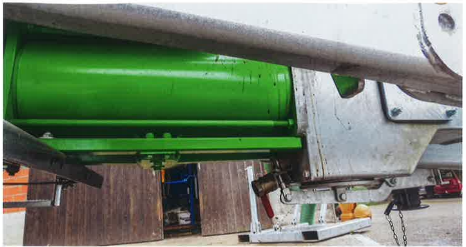
Die Schneckenpumpe wird von Bauer selbst produziert und schöpft bis 4000 l/min bei maximal 6 bar.
