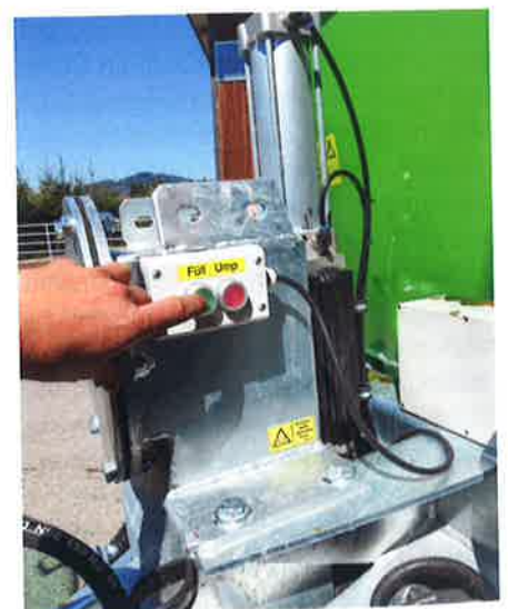
Mit dem grünen Knopf wird die Befüllautomatik eingeschaltet, sobald das Fass voll ist schaltet die Steuerung auf den roten Knopf für das Umwälzen.
