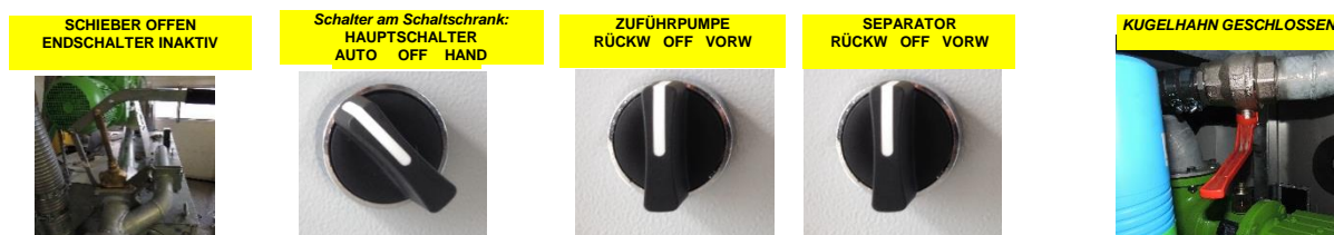
Abbildung 19 Hebel und Schalterstellung im Automatikbetrieb ohne Ablaufpumpe
