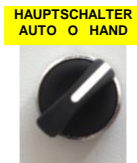
Abbildung 12 AUTO - 0 - HAND Schalter
