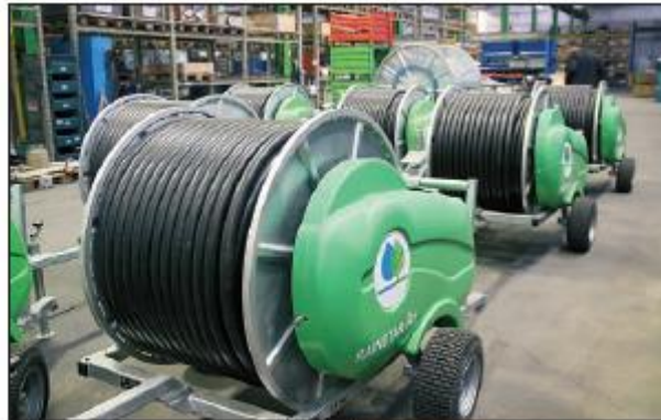
Diese Trommeln sind für die Beregnung auf Golfplätzen bestimmt.
