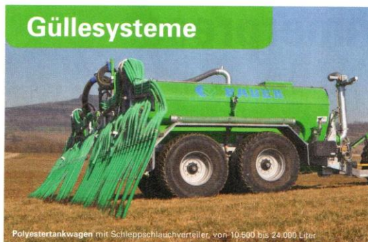
Polylestertankwagen mit Schleppschauchverteiler, von 10.500 bis 24.000 Liter
