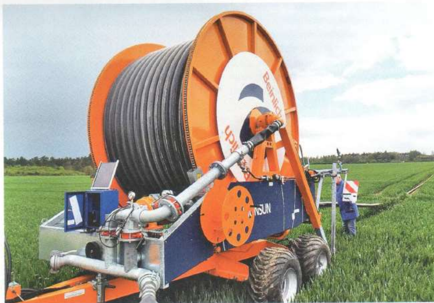
Neben der Beregnungsmaschine Monsun hat die Beinlich Agrarpumpen und -maschinen GmbH viele weitere Baureihen im Sortiment. Für das Modell Monsun sind fünf Trommelgrößen verfügbar.
