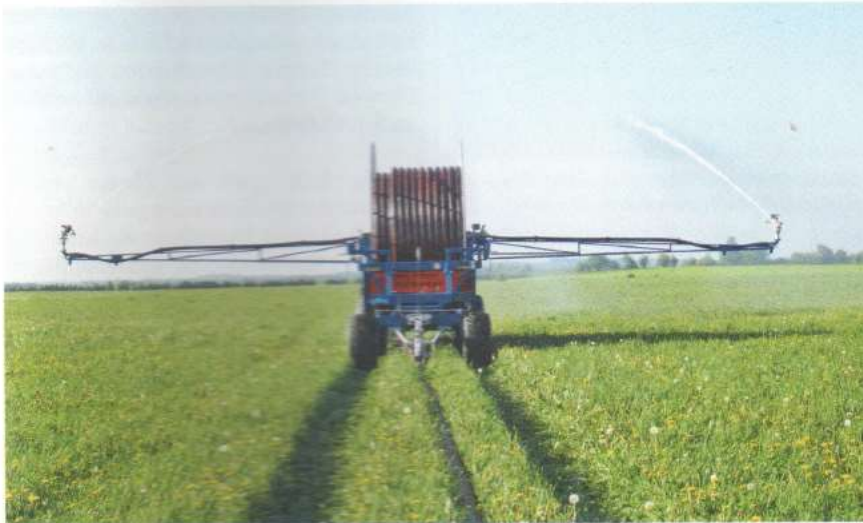
Der FASTERHOLT-Ausleger ist 24 Meter breit und jeweils mit einem Nelson SR 100 Mittelstarkregner ausgestattet. Eine feinere Tröpfchengröße und weniger Windanfälligkeit sind laut Hersteller wesentliche Vorteile.
