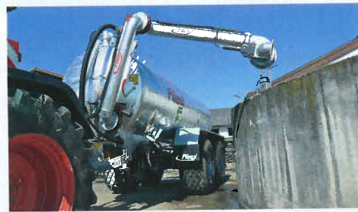
Der Turbosauger Elefant hat eine Befüllleistung von 7000 l/min.
