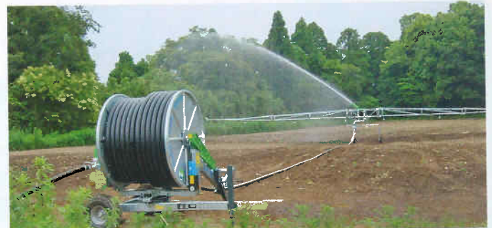
Für einen besonders Pflanzen schonenden Niederschlag kann der SmartRain mit einem 16 m breiten Auslegerstativ ausgestattet werden.
