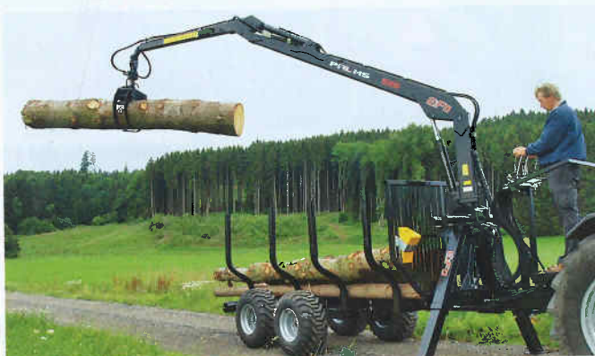
Der Kran hat eine Reichweite von über 5 m.
