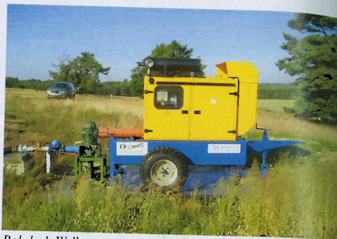
Bohrloch-Wellenpumpe mit Antrieb per Dieselaggregat.
