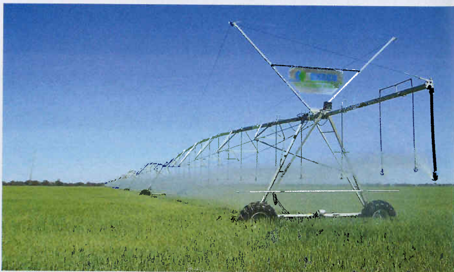
Pivot- oder Linearanlagen arbeiten vollautomatisch. Sie geben das Wasser in feineren Tropfen ab, die Intensität im Beregnungsstreifen ist allerdings höher als bei einer Kanone.
