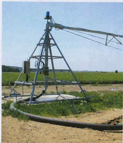
Vorteil der Pivot-Anlage: Wassereinspeisung am zentralen Ankerpunkt.
