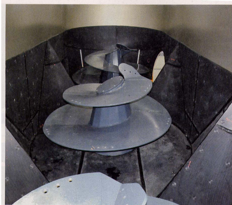
▲ Eckart Maschinenbau | Verschleißschichten aus Polyethylen im Feststoffdosierer erhöhen die Standzeiten der kompletten Einbringtechnik und senken die Wartungs- und Betriebskosten. Durch die guten Gleiteigenschaften des Kunststoffes soll eine Kräfteinsparung von bis zu 20 Prozent möglich sein. Geeignet für Eckart-Einbringsysteme und andere Fabrikate. Halle 17, Stand C30b
