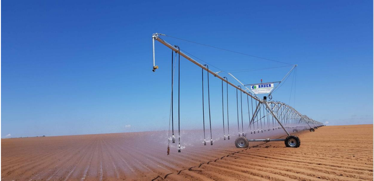
Diese Niederdruck-Beregnungsanlage beregnet Kartoffeln in der Ankeimphase in Brasilien
