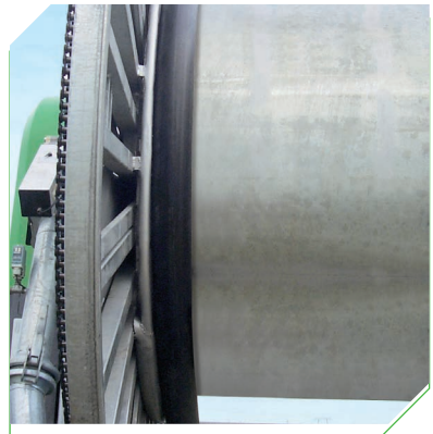
GESCHLOSSENER HASPELKERN Der Haspelkern jeder RAINSTAR Trommel ist voll geschlossen und mit einem Abweisbogen ausgestattet.
