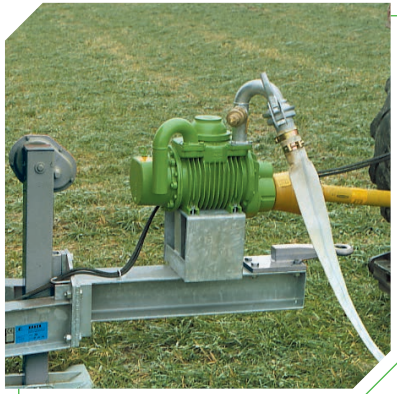
AUSBLASEVORRICHTUNG Optional - Ausblasen des PE-Rohrs mit Original BAUER-Kompressor und optimal auf den Rohrdurchmesser abgestimmten Ausblaseball.
