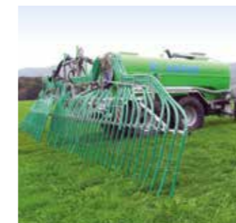
Distribuidor de manguera de arrastre Sistema modular para todo tipo de camiones cisterna
