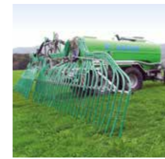
Schleppschlauch- verteiler Baukastensystem für alle Typen von Tankwagen
