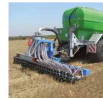
Einbring-Schlitzgerät Innovative Ausbringtechnik
