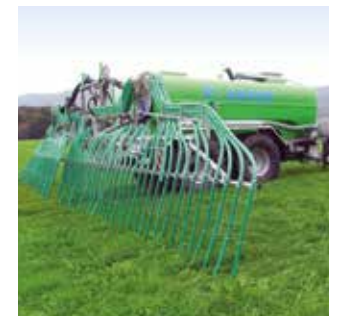
Distribuidor con manguera de arrastre Sistema modular para todo tipo de tanques
